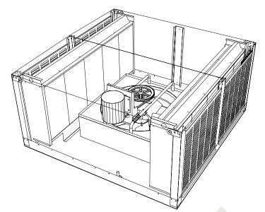
Fan-Air<sup>®</sup> Evaporative Cooling
